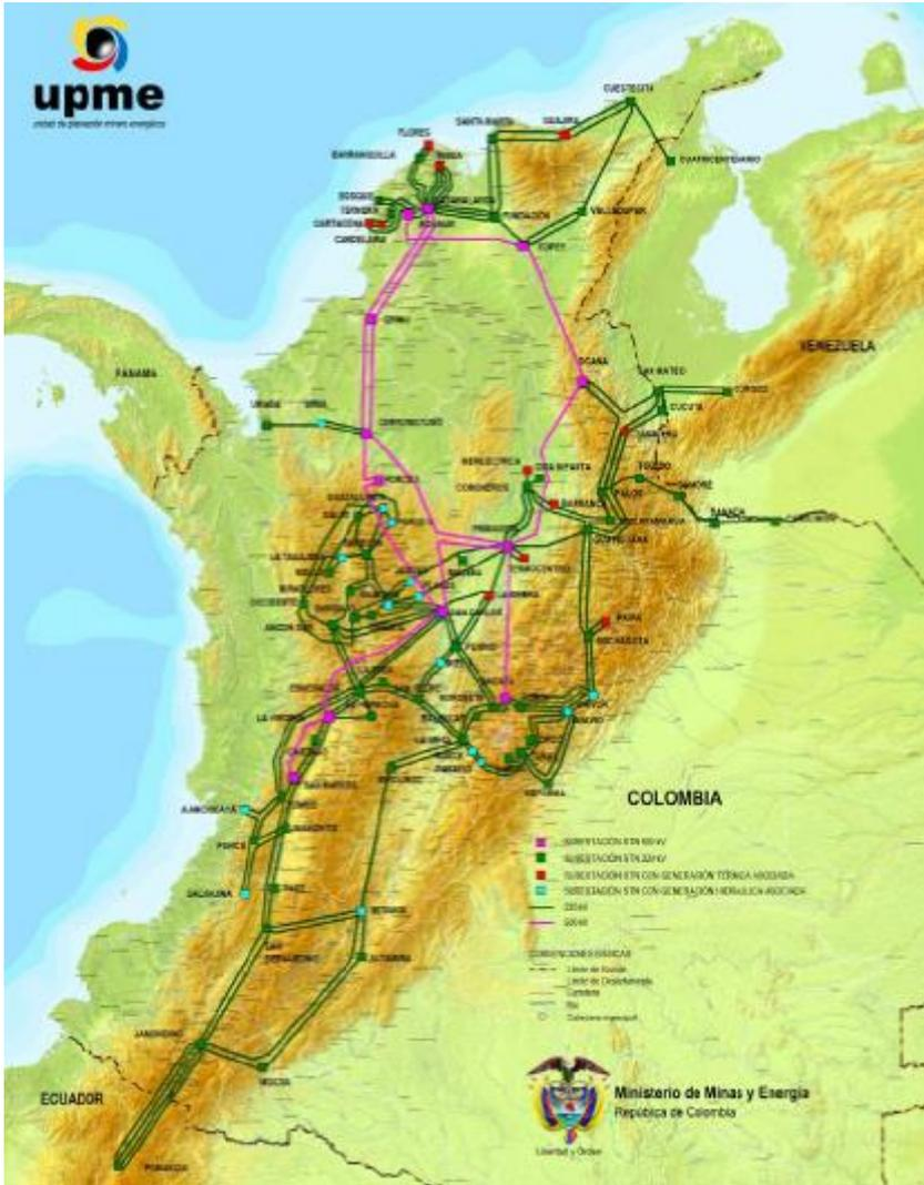
Es el sistema de transmisión de energía eléctrica compuesto por el conjunto de líneas y subestaciones con sus equipos asociados, transformadores con sus respectivos módulos de conexión, que operan a tensiones iguales o superiores a 220 kV.
