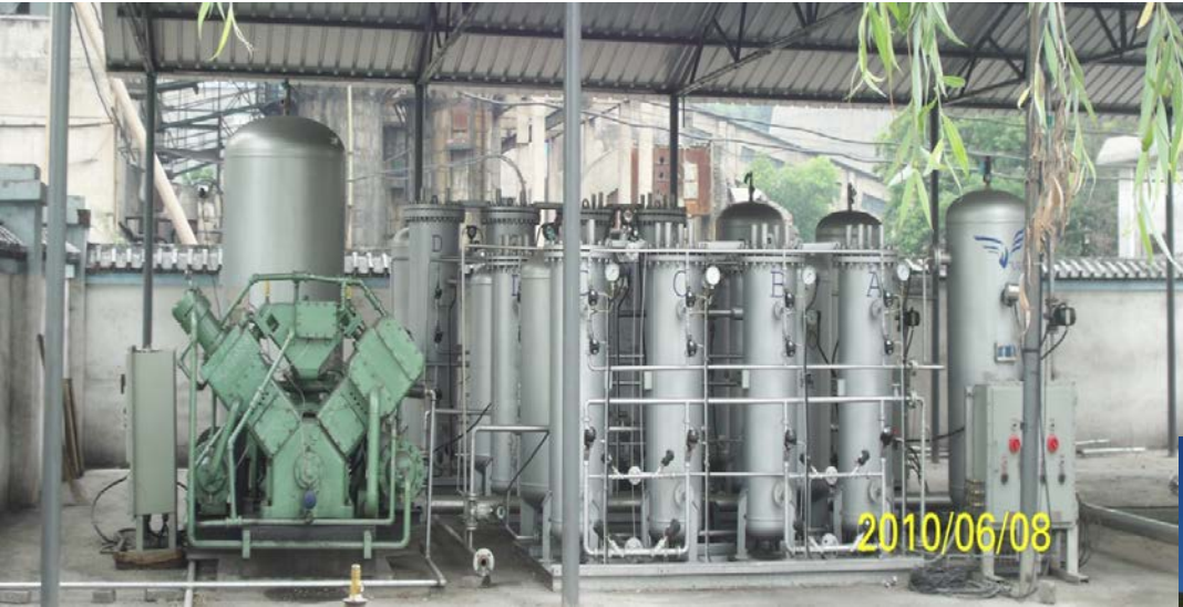
100m 3 /h煤层气浓缩提纯中试装置2010年7月 100m 3 /h coalbed methane Enrichment and purification plant, Jul.2010.
