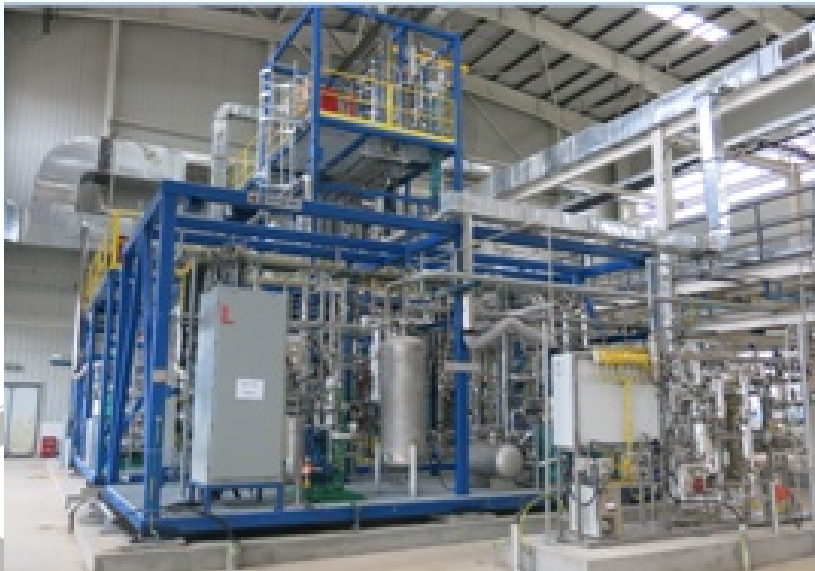
1桶/天油煤共炼中试装置
